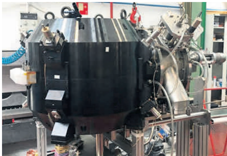
Ciclotrón SC para producción de radio isótopos para imagen médica PET de Antec Magnets.
